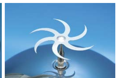
Ketika kincir listrik bermuatan, pengosongan muatan mendorong ujung-ujung kincir sehingga kincir berputar bebas pada porosnya.
