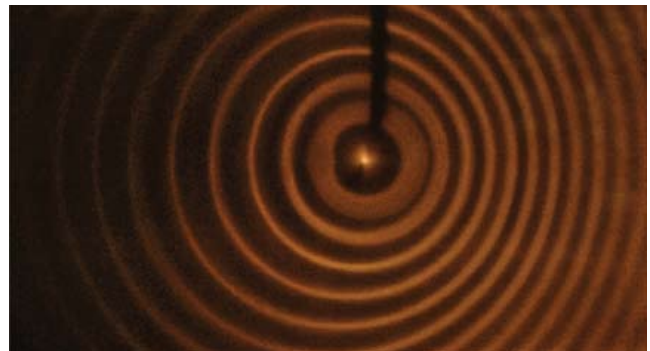
Dengan Tangki Riak FGE 13 ini dapat dilakukan percobaan efek Doppler.
