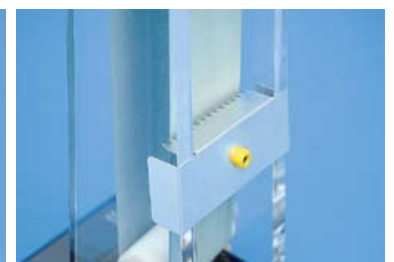
Tersedia sisir tambahan untuk meningkatkan muatan listrik pada bola berongga Van de Graaff
