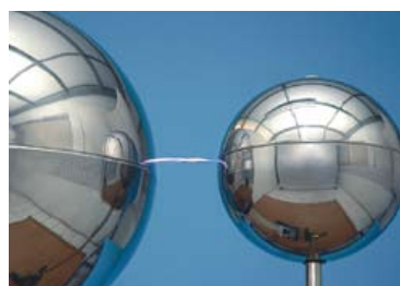
Jarak busur listrik maksimum 50 – 100 mm, bergantung pada kondisi kelembaban lingkungan.
