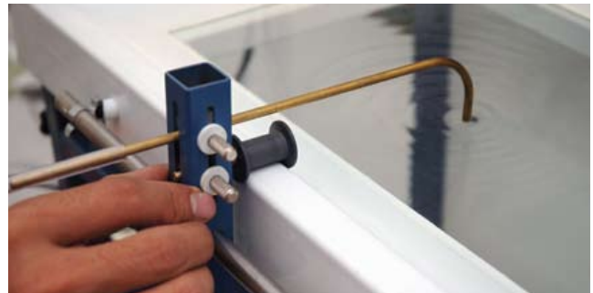
Mekanis geser untuk percobaan efek Doppler
