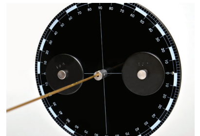
Posisi beban cakram dapat diatur pada jarak 4, 6, 8, 10 cm dari pusat.
