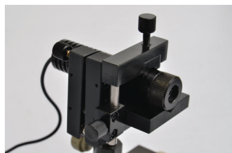
Arah sinar laser dapat diatur pada dudukan laser.
