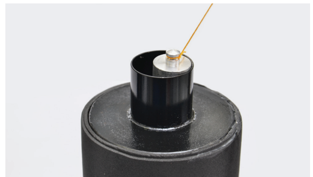
Proses pemanasan silinder logam di dalam tabung pemanas.
