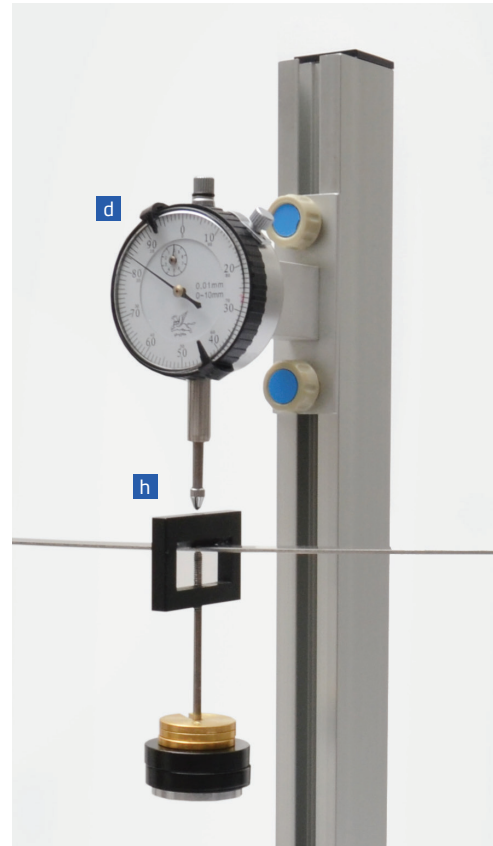
Balok meregang akibat diberi beban hingga batas elastisitasnya.
