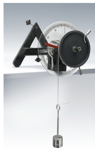
MI-01 Konstanta Pegas Spiral Alat Momen Inersia
